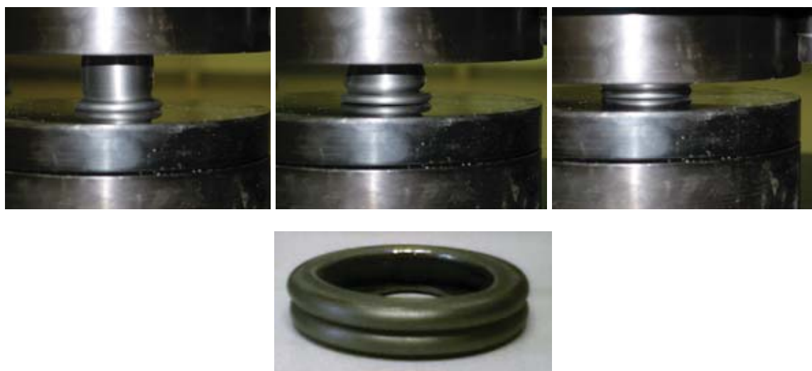
Rys. 7. Proces i charakter deformacji tulejki stalowej Fig. 7. Process and character of deformation of the steel sleeve
