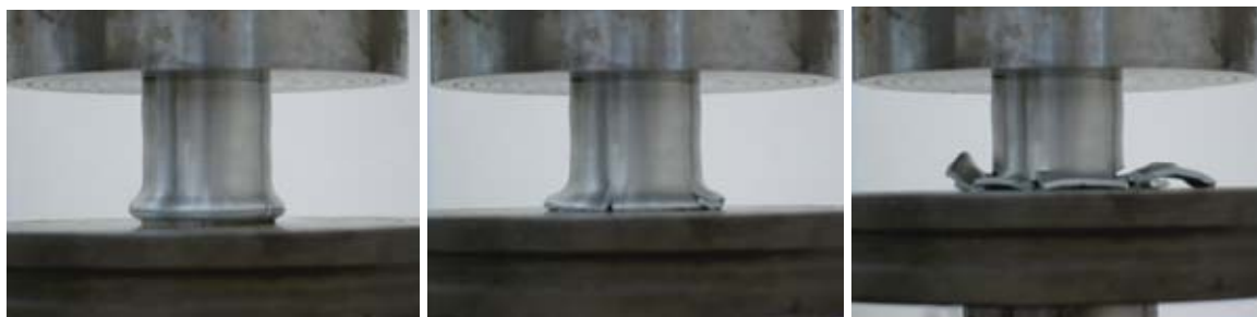
Rys. 15. Sposób deformacji tulejki duraluminiowej Fig. 15. Deformation mode of the duralumin sleeve
