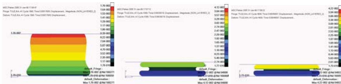
Rys. 9. Sposób deformacji numerycznego modelu tulejki stalowej Fig. 9. Deformation mode of the steel sleeve numerical model
